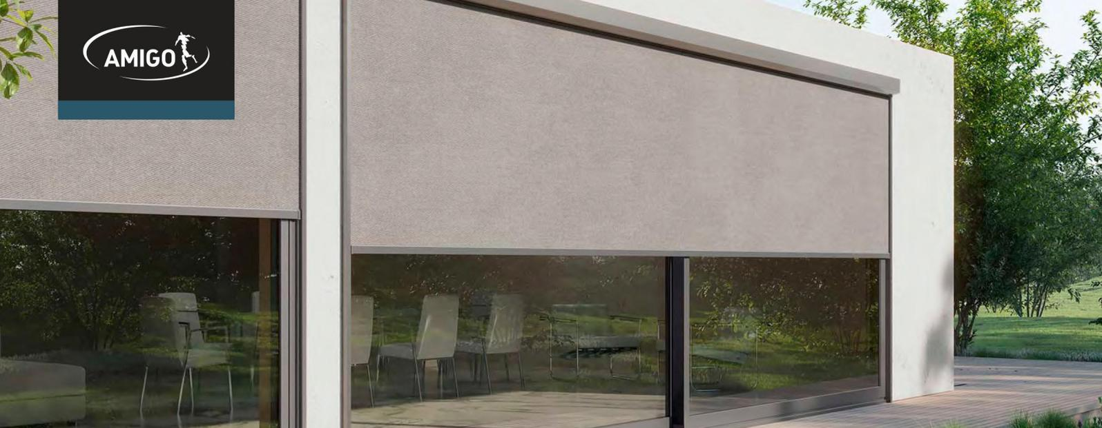
**РУЛОННАЯ ШТОРА ZIP** – это штора в кассете современной квадратной формы, в которой в качестве полотна используются, как правило, ткани СКРИН или специализированные пленки. По бокам к полотну по всей его высоте приварены молнии, которые в свою очередь входят в специальные пазы внутри боковых направляющих. Тем самым создается натяжение ткани в стороны и полностью исключается ее выпадение из направляющих даже при сильном ветре.
