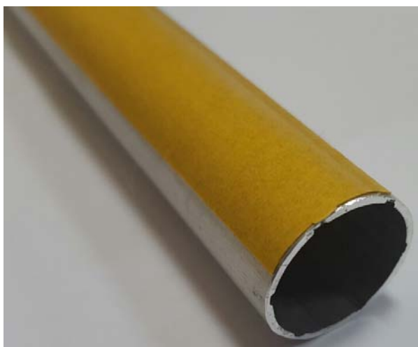
Рис. Наклеивание клейкой ленты на трубу
