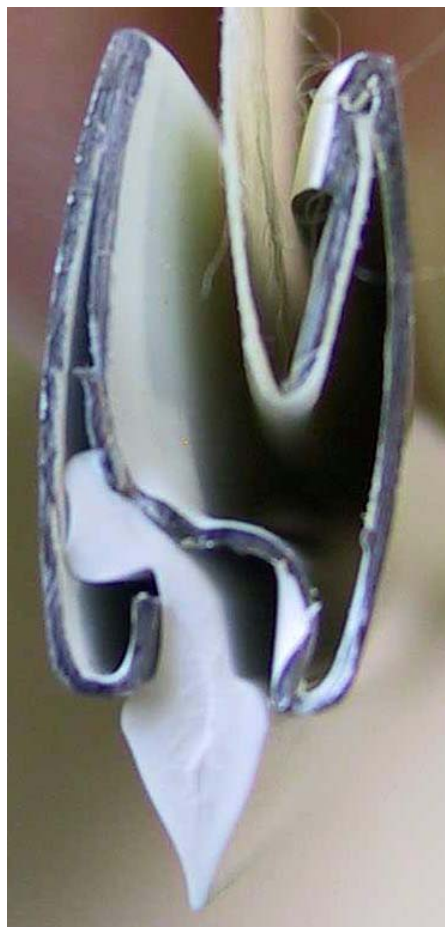
Рис. Нижняя планка в сборе Вставить нижние боковые крышки (311070) в оба конца нижней планки.
