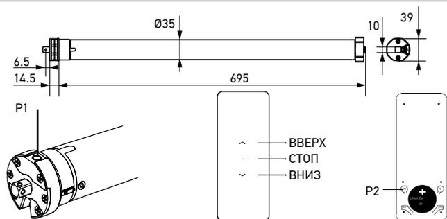
*Из-за особенностей работы привода со встроенным аккумулятором все настройки должны производиться с радиопередатчика/канала, индивидуального для данного привода. В противном случае изменения настроек могут затронуть другие приводы, запрограммированные на данном радиопередатчике/канале*
