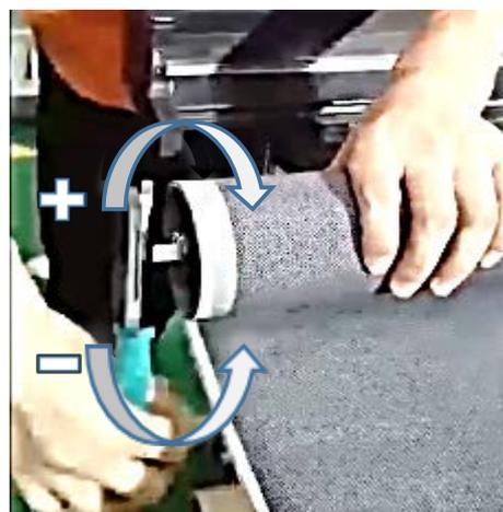
Если нужно увеличить натяжение пружины, вращайте ручку отвертки по часовой стрелке один - два полных оборота. Если, наоборот, нужно ослабить натяжение пружины, вращайте ручку отвертки против часовой стрелки один- два оборота.
