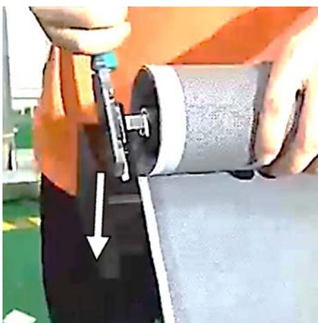
Не вытаскивая отвертку из отверстия вставьте вал с креплением пружины в короб. Убрав отвертку проверьте натяжение пружины потянув рукой за утяжелитель. Если натяжения не достаточно или наоборот слишком много, повторите операции первых трех пунктов
