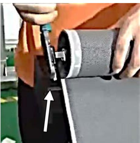
Держа одной рукой вал, другой отвертку, вставленную в пространство между боковой пластиной и держателем пружины, извлеките вал с креплением со стороны пружины из короба. С противоположной стороны вал с креплением заглушки остается в коробе.
