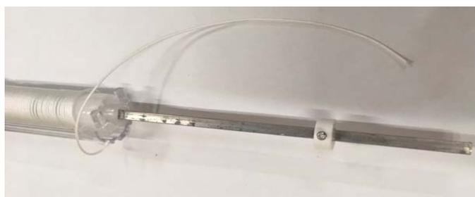
3.8. Надеть на мотор *Зажим для мотора в римский карниз DS440F* с двух сторон:
