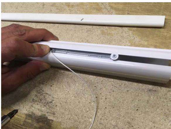
3.12. Зафиксировать *Кольцо стопорное, квадрат 5мм* винтом, расположив его вплотную к шнуронамотке.
