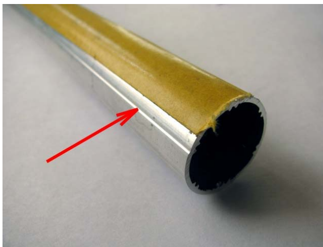
Рис. Наклеивание клейкой ленты на трубу
