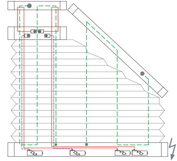
6 Drahtbohrungen/Wire boreholes/Passages de fil
