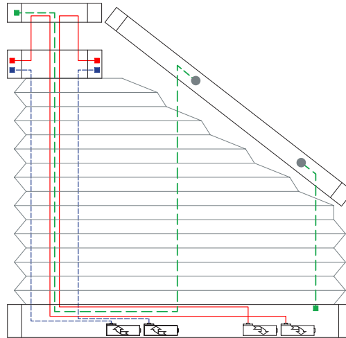
3 Drahtbohrungen/Wire boreholes/Passages de fil
