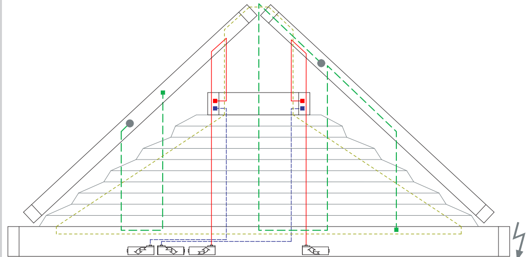
5 Drahtbohrungen/Wire boreholes/Passages de fil
