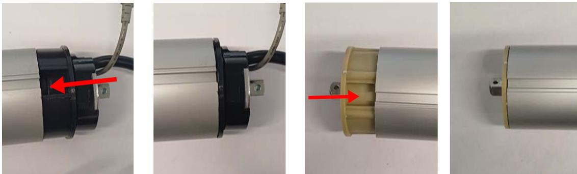
14) Соберите кронштейны для подвеса. Верхнюю часть кронштейна не прикручиваем до установки LIFT системы.
