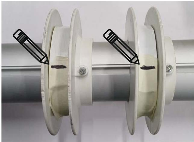
16) Возьмите крепеж для ремня LIFT (803015-0000). Выкрутите полностью один винт и ослабьте второй винт.
