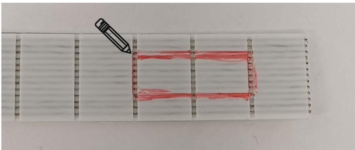
6) Сложите ремень LIFT (803015-0000) пополам по середине отметки, сделайте канцелярскими ножницами вырез по краям отметки
