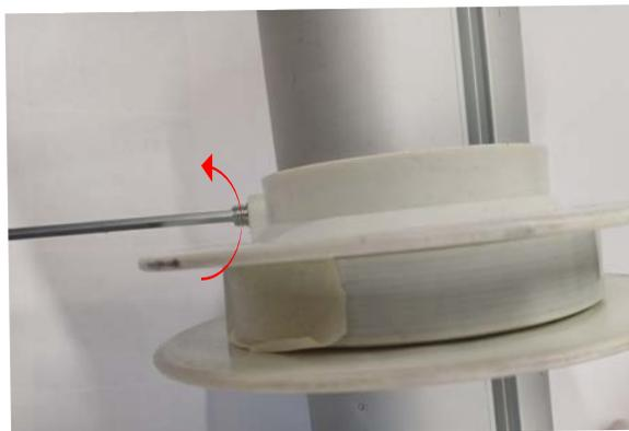
11) При наличии двух труб, вставьте в каждую из них промежуточные заглушки, просверлите по три отверстия диаметром 3,5 мм в каждой трубе и зафиксируйте заглушки саморезами 3,5x13 DIN7981C (310469-0000)
