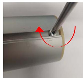
12) Установите в привод DM 45 адаптер для трубы 63мм LIFT (803011-0000) и переходник DM45-труба 63мм LIFT (803021-0000), зафиксировав фиксатором из комплекта привода.
