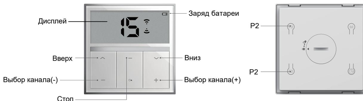
Радиовыключатель DD1853P служит для управления приводами Amigo как обычными, так и с обратной связью. Использование режима с обратной связью даёт ряд дополнительных преимуществ, таких как повышенная помехоустойчивость и быстрый отклик на команду из-за улучшенной кодировки сигнала. По умолчанию радиовыключатель работает в режиме с обратной связью.
