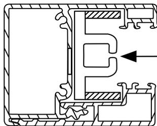
После установки направляющих рекомендуется смазать вставки направляющих силиконовой смазкой по всей длине направляющих, для более плавной работы системы.
