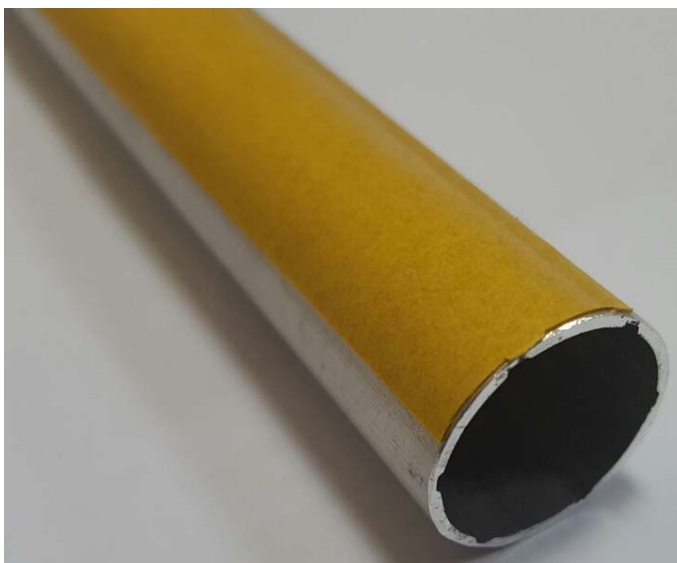
Рис. Наклеивание клейкой ленты на трубу
